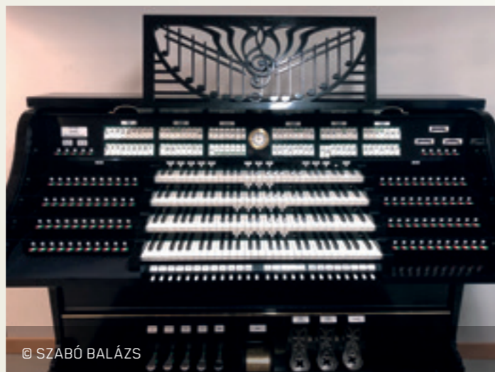
A VILÁG ELSŐ TISZTÁN ELEKTROMOS JÁTSZÓASZTALA MOZGATHATÓ, A SZÍNPAD BÁRMELY PONTJÁRA ELHELYEZHETŐ VOLT. © ANTALFFY ORGONAISKOLA ILLUSZTRÁCIÓJA
