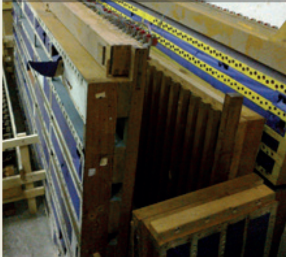
A VOIT-ORGONA EREDETI SZÉLLÁDÁI A RAKTÁRBAN. A FURATOKON KERESZTÜL KAPNAK A SÍPOK LEVEGŐT. © SZABÓ BALÁZS
